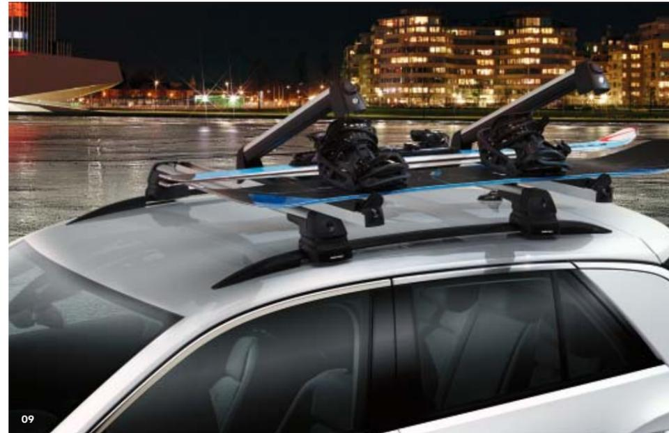
**07** Die **Tragstäbe** bilden die Systembasis für alle Aufbauten. Sie sind stabil, leicht und vor allem schnell an der Dachreling anzubringen. Dank der diebstahlhemmenden Verschlusseinrichtung sind Sie vor bösen Überraschungen geschützt. **SO**
