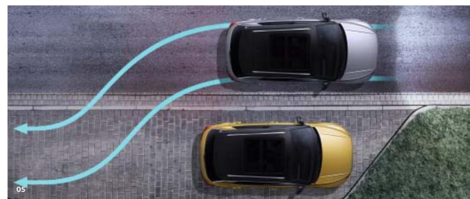
**04** Mit dem **Umfeldbeobachtungssystem** „Front Assist“ inklusive Fußgängererkennung sind Sie entspannter unterwegs. Wird eine kritische Auffahrsituation erkannt, warnt der „Front Assist“ den Fahrer. Wird die brenzlige Situation nicht entschärft, leitet das System automatisch den Bremsvorgang ein. Auch Fußgänger, die plötzlich auf die Fahrbahn treten, können damit besser erkannt werden.<sup>1)</sup> **S**
