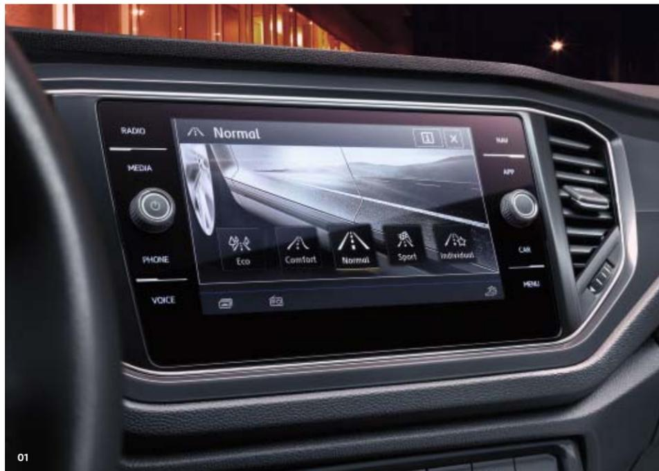
**01** Mit der optionalen **Fahrprofilauswahl** steht Ihnen immer das passende Fahrprofil zur Verfügung: Normal, Eco, Sport, Comfort oder Individual. Die Motor- und Getriebeabstimmung sowie das Verhalten bestimmter Assistenzsysteme werden so den Gegebenheiten angepasst. Mit dem Individual-Profil können Sie tiefer in die Einstellungen eingreifen und sie nach Ihren Vorstellungen modifizieren. **SO**
