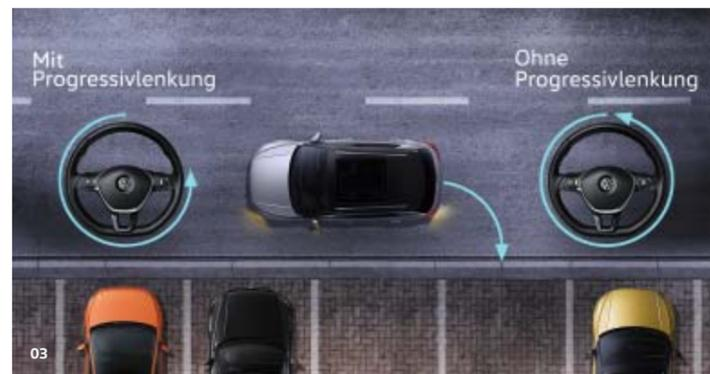
**03** Die **Progressivlenkung** des neuen T-Roc Sport ermöglicht eine bessere Kontrolle bei sportlichem Fahren und sorgt für zusätzlichen Komfort im alltäglichen Gebrauch. So reduziert das progressive Übersetzungsverhältnis die Lenkarbeit beim Einparken und erhöht zugleich die Fahrdynamik durch ein direkteres Lenkverhalten auf kurvenreichen Straßen. **SP SO**
