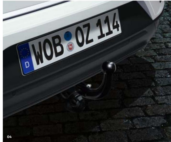
**04** Sei es der Bootsanhänger, der Motorradanhänger oder der zusätzliche Stauraum – um einen Anhänger zu transportieren, benötigen Sie eine **Anhängevorrichtung**. Lieferbar ist sie als starre (siehe Abb.) oder mechanisch schwenkbare Variante. Der 13-polige Elektro-Einbausatz gewährleistet die elektrische Versorgung und ermöglicht somit den Betrieb eines Anhängers und unterstützt das Parkassistenzsystem sowie die Gespannstabilisierung. **SO**
