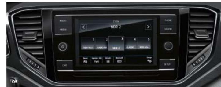
**04** Zum optionalen **Radio „Composition Media“** gehören sechs Lautsprecher. Es enthält alle Funktionen und Anschlussmöglichkeiten des „Composition Colour“ sowie ein CD-Laufwerk, eine USB-Schnittstelle und eine Bluetooth-Anbindung für Mobiltelefone. Zudem ist es mit einem 20,3 cm (8 Zoll) großen Touchscreen-Farbdisplay besonders komfortabel zu bedienen. **SO**
